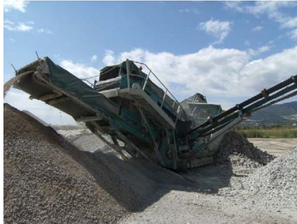
Figura 9. Cintas transportadoras y acopios de distintas granulometrías.
