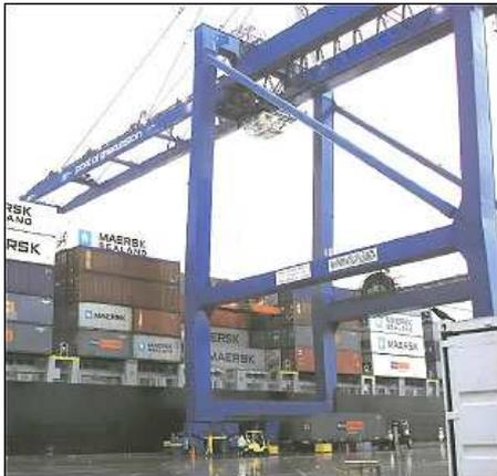
Todas las unidades utilizadas en la manipulación de contenedores están provistas de un bastidor fijo o telescópico, llamado **spreader**, que sujeta al contenedor mediante un sistema de giro mecánico (**Twist-Lock**) situado en las cuatro esquinas. Este mismo sistema de cierre se utiliza manualmente para la sujeción de los contenedores transportados en camiones plataforma.
